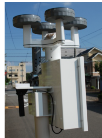
非接触路面熱収支計
