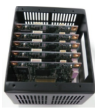
カメラユニット FPGAを実装した 画像処理専用基板
