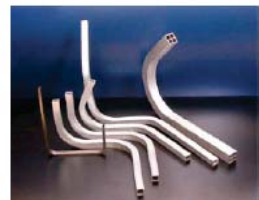
アルミ角材の曲げ加工例
