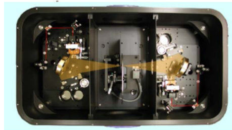
Aispec THz-TDS : Pulse IRS1000/2000 の外観(左)・内部光学系 写真(右) 種々の附属光学ユニット が装着される汎用分光分 析装置
