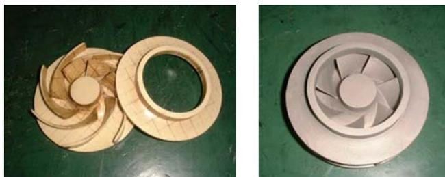
インペラーのLOM(紙積層)モデルと精密鑄造品
