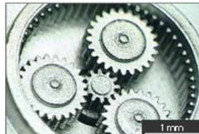
\mu -MIM部品:マイクロ遊星歯車 SUS316L 遊星歯車の直径:1.7mm モジュール:0.07
