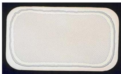
Nb<sub>3</sub>Sn超伝導線断面
