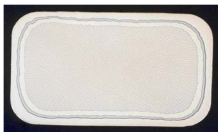
Nb 3 Sn超伝導線断面 (線材メーカー提供)
