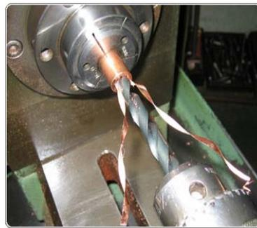
切削クズが刃に食いつかず加工箇所から排出する技術によるガンアーム加工
