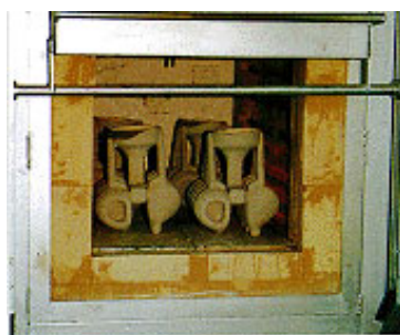
ロストワックス法による鑄造の様子
