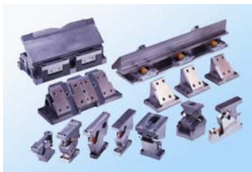
プレス金型用オイルレスカムユニット プレス加工で、穴あけ、曲げなどの工程で上下運動を左右運動に変換するモジュールユニット。
