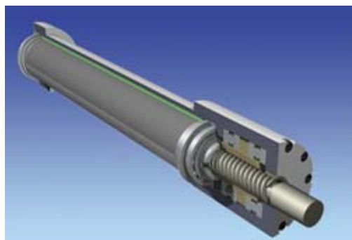
増幅機構付き減衰装置「減衰こま」 地震時に発生する構造物の変形を「すべりねじ」を介して回転運動に変換し、摩擦力を利用して地震動を減衰させます。
