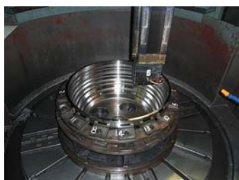
ジェットエンジン部品のターニング加工
