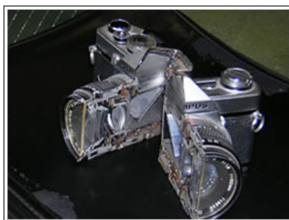
ダイヤモンドマシンで切断したカメラ（切断面にバリや欠けがない）
