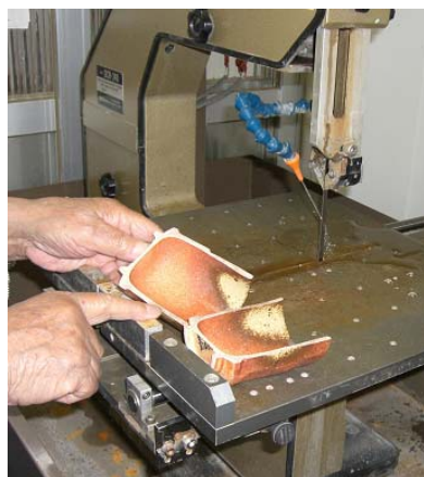
ダイヤモンドマシンで陶器を切断（指で触っても大丈夫）
