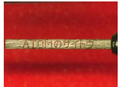
\phi 0.5\text{mm} のシャープペンの芯に \phi 0.05\text{mm} のドリルで穴をあけ、 文字を加工
