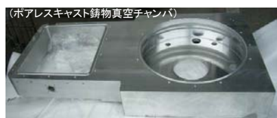
圧延材削出し品の鋳物化
