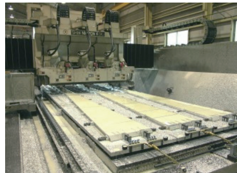
5軸加工機による精密切削加工
