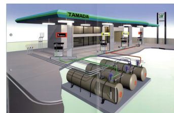
SF二重殻タンク施工例
