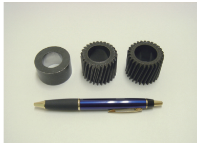
成形工程 1工程 → 2工程 → 3工程
