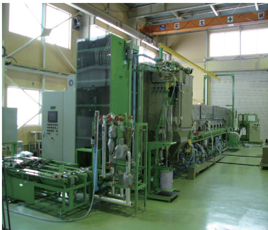
防振ゴム用金具のウェットブラスト処理装置
