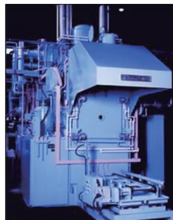
量産型雰囲気制御付真空浸炭炉
