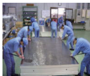
キサゲ加工の様子 スクレーパーによる手作業
