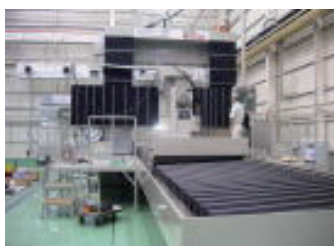
国内に1台しか無い CNC大型精密平面研削盤
