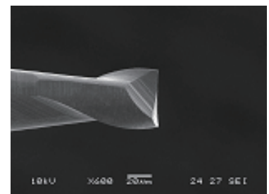
マイクロエッジ NSME230 刃径φ0.03mm
