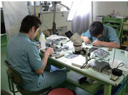
金型製造（金型部品の組込み）
