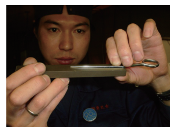
5μm単位の刃と刃の間隙を調整
