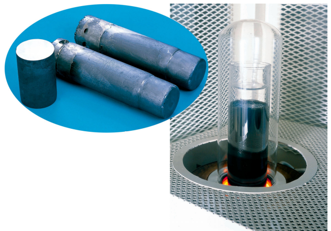
CdTe単結晶インゴット(円内)とその製造装置
