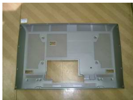
製作金型で成形された薄型テレビ背面カバー
