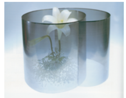
1インチ平方に0.25mmφの孔が、4055個開いている開孔率が30.7%の極小孔・高密度パンチングメタル
