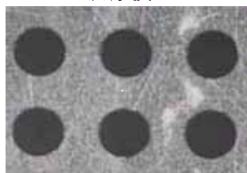
ウエハーバンプ印刷用マスク 開口径50 \mu m 鉛レス半田洗浄
