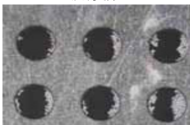
ウエハーバンプ印刷用マスク 開口径50 \mu m 鉛レス半田洗浄
