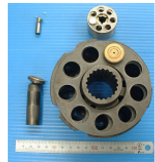
上はタカコ製小型ポンプ部品 下は従来のポンプ部品
