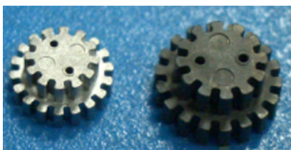
金属成形体並びに焼結体 高さ1.5mm穴径300μm
