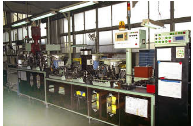
ユニバーサルジョイント社内製組立機
