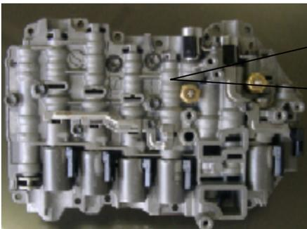
油圧制御装置内バルブボディ
