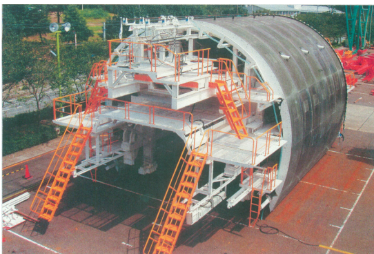
GIFUコート使用のトンネル用型枠
