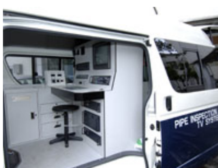
配管内調査の映像を専用車両でモニタリング・解析
