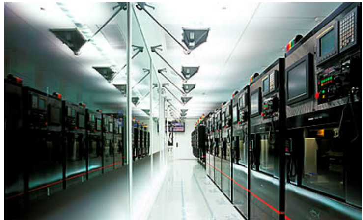
工場に並ぶ金型加工用超高速工作機械
