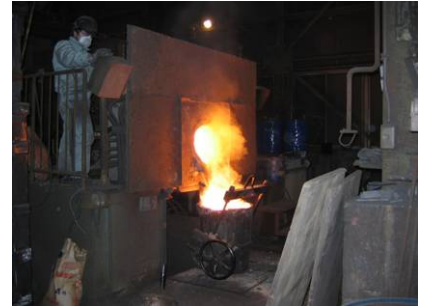
電気炉から注ぎ込まれる溶湯 (溶かした鑄鉄)
