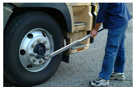
大型輸送機のホイール締め付け作業例
