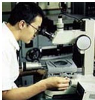
顕微鏡による精密ばねの検査
