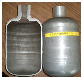
特殊加工例(首の部分だけ厚みを増している)
