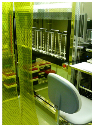
微細欠陥検査装置 (クリーンルーム内に、さらに * クラス1 のクリーン環境をつくり洗浄・検査を行 う)
