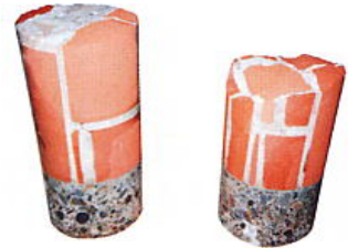
ひび割れ補修後の状態
