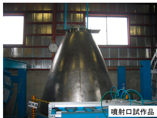
自社開発したロケット 噴射口自動溶接治具 (曲面パネル用)
